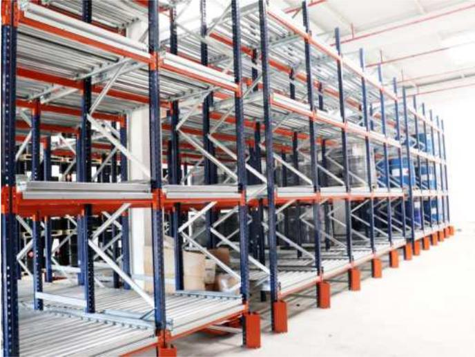
Une fois une palette retirée, la suivante se déplace automatiquement et en toute sécurité grâce à des freins et des séparateurs mécaniques. La rotation optimale des stocks (FIFO) garantit que le premier produit stocké est le premier à être utilisé,
