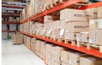
Les palettes sont directement posées sur les lisses, sans nécessiter de platelage intermédiaire. Cette configuration est idéale pour les palettes stables et standardisées, optimisant ainsi l'espace de stockage et facilitant l'accès.
