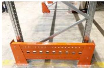
Ce système est conçu pour être installé sur les cadres externes et dans les zones exposées aux chocs accidentels. Il protège les échelles de vos rayonnages ainsi que les allées et se fixe solidement grâce à quatre ancrages en acier.
