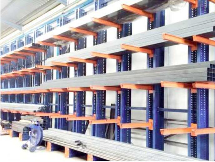
système comprend des colonnes verticales avec des bras mobiles qui, en cas de choc, se relèvent pour prévenir tout dommage à la fois sur la charge et la structure. Ainsi, la durée de vie de l'installation est prolongée.
